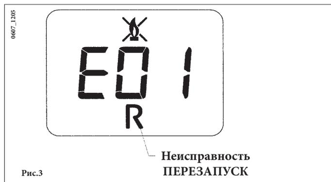
Для перезапуска котла используйте переключатель режимов (Рис.2) на 2 сек в положение «R». При повторных срабатываниях данного устройства обратитесь в обслуживающую организацию.
