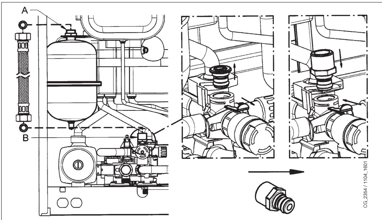
Соединить гибкую трубу (поставляется как принадлежность в комплекте расширительного бака) с двумя патрубками А и В, как показано на рисунке. Монтаж расширительного бака ГВС рекомендуется в тех случаях, когда:
