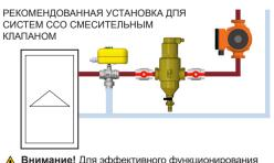
▲ Внимание! Для эффективного функционирования деаэрато-грязеуловитель должен всегда устанавливаться в горизонтальном участке трубопровода с корпусом, направленным вверх.
