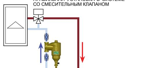
В верхней части сепаратора расположено резьбовое отверстие 1/2" с заглушкой, в которое может быть установлен автоматический воздуховыпускной клапан. Автоматический воздуховыпускной клапан FAR присоединяется простым вкручиванием воздухоотводчика после снятия заглушки.
