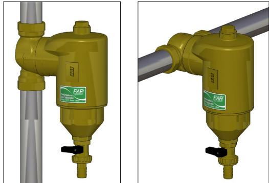
En la parte superior del separador se encuentra una conexión rosada con un tapón donde se puede instalar un purgador automático para facilitar la expulsión de los gases. Para la eventual instalación de este purgador automático FAR, quitar el tapón y enroscar el purgador. La conexión superior es siempre de 1/2" en todos los modelos FAR.
