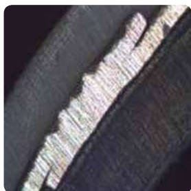
Шов алюминия, сваренного внахлест
