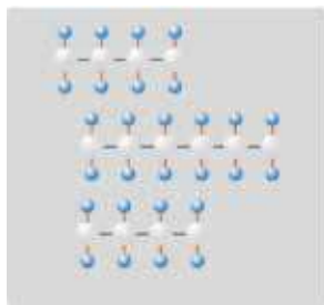
Молекулярная структура обычного полиэтилена
