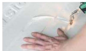
Дополнительные каналы могут быть выпилены электроинструментом
