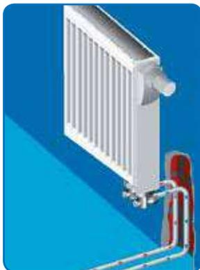
г) Подключение радиатора «нижнее, от стены» непосредственно с помощью труб Уропог. Присоединение труб к радиаторному узлу осуществляется резьбовыми адаптерами или пресс фитингами.
