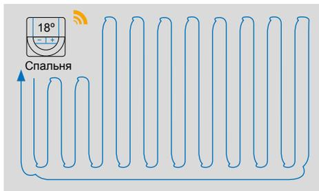
Автобалансировка обеспечивает подачу теплоносителя в контуры напольного отопления импульсами. Длительность этих импульсов рассчитывается для каждого помещения отдельно, и для помещений с короткими контурами она меньше, чем для помещений с длинными контурами. При этом расходуется именно необходимое количество энергии.
