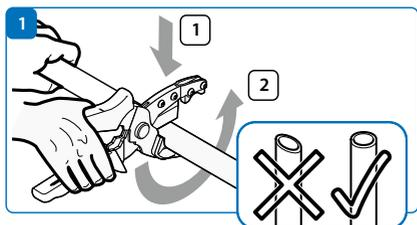
Отрежьте конец трубы труборезом. Торец трубы должен быть под прямым углом, без заусенцев.
