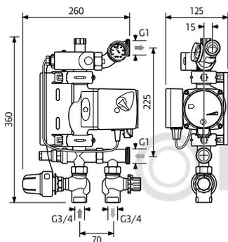
Предназначен для непрерывного регулирования температуры подачи в системах поверхностного отопления в одном или нескольких помещениях. Комплект в сборе, включает:
