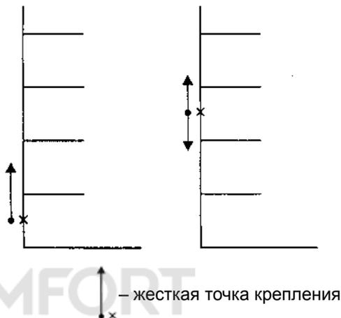
новки хомутов на муфтах места крепления Uronor Wipex или в местах уставки колена Uronor Wipex. В местах монтажа запорно-регулирующей арматуры на трубах Uronor PE-Xa также следует применять хомуты.
