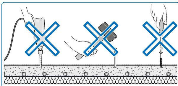
Работы на стяжке можно производить только после набора ее 70% прочности, т.е. примерно через 5 дней.
