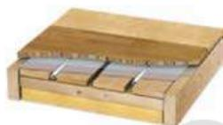
Конструкция пола с пластиной для распределения тепла может применяться как для напольного, так и для настенного отопления.
