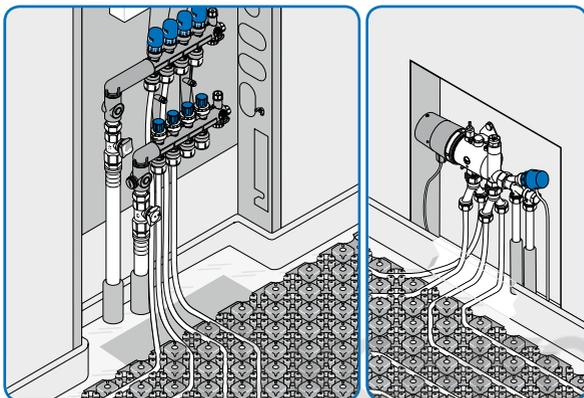
Примеры монтажа модульного пластикового коллектора и насосно-смесительного блока Uponor Push 12.
