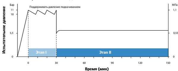
\* Если в системе имеются пресс фитинги, перед гидравлическими испытаниями следует провести их проверку (3 бара, 15 минут).
