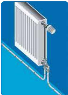
к) Подключение радиатора «нижнее, от пола» непосредственно с помощью труб Уропог. Присоединение труб к радиаторному узлу осуществляется резьбовыми адаптерами или пресс фитингами.
