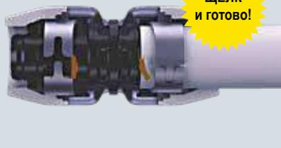
*Специальный индикатор внутри фитинга выполняет целый ряд функций: цвет обозначает диаметр фитинга, надёжная фиксация предотвращает преждевременное срабатывание, щелчок и визуально видимое смещение гарантированно подтверждает, что стальное кольцо сомкнулось и соединение выполнено и герметичность достигнута.*
