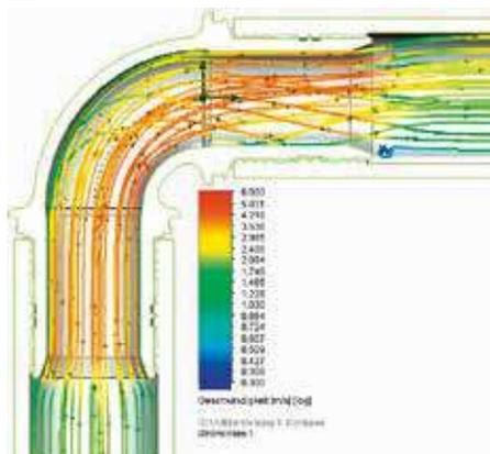
Оптимизированная конструкция фитинга. Соединительные пресс-фитинги S-Press PLUS сконструированы таким образом, чтобы исключить возникновение застойных зон во внутреннем пространстве и избежать возникновения биологического загрязнения питьевой воды из-за её застоя. Это доказано микробиологическими исследованиями в Институте гигиены окружающей среды и токсикологии в Гельзенкирхене.
