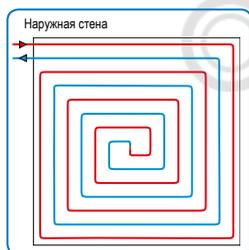
При применении спиральной раскладки подающая и обратная труба находятся рядом друг с другом. Это обеспечивает относительное постоянство температуры поверхности.
