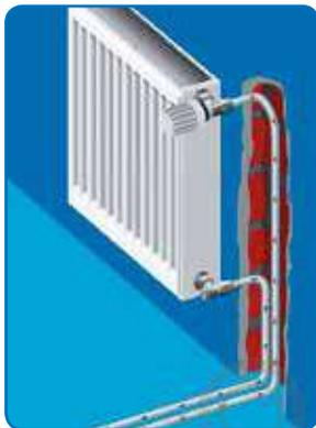
а) Подключение радиатора «боковое, от стены» непосредственно с помощью труб Уропог. Присоединение труб к радиаторному узлу осуществляется резьбовыми адаптерами или пресс фитингами.
