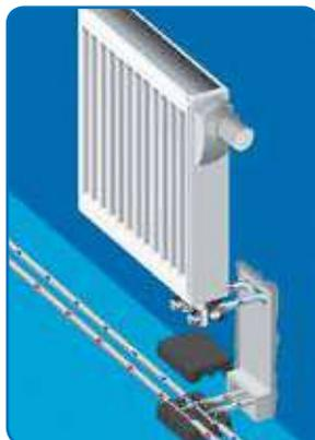
и) Подключение радиатора «нижнее, от стены». Присоединение труб к радиаторному узлу осуществляется резьбовыми адаптерами или пресс фитингами. Для пересечения подающих и обратных труб в одной плоскости используется крестовина.
