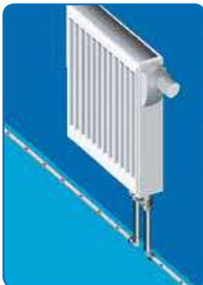
л) Подключение радиатора «нижнее, от пола» с помощью хромированных медных пресс угольников. Присоединение медных пресс- угольников к радиаторному узлу осуществляется резьбовыми адаптерами для медных трубок.
