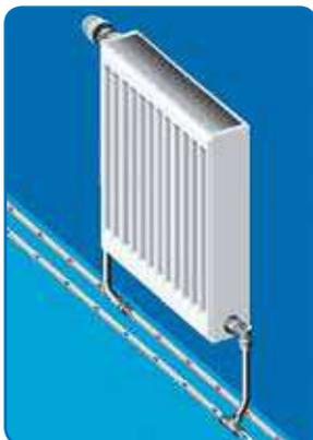
з) Подключение радиатора «бокковое, от пола» с помощью хромированных медных пресс тройников. Присоединение медных пресс тройников к радиаторному узлу осуществляется резьбовыми адаптерами для медных трубок.
