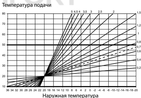
Выбор кривой зависит от комбинации разных факторов, таких как качество изоляции корпуса, географическое местоположение, тип системы отопления/охлаждения и т. д.
