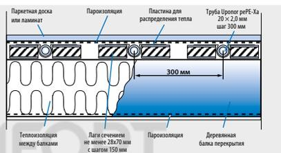
схеме. При необходимости положите пароизоляцию. Отметьте трассу труб, чтобы предотвратить случайное прокалывание их саморезами. Затем уложите древесно-стружечные плиты ДСП, фанеру или гипсо-волоконные листы ГВЛ (минимальная толщина 22 мм) поперек лаг секциями по 600 мм и зафиксируйте саморезами. Стыки шпунтового соединения необходимо проклеить.
