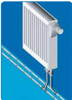
ж) Подключение радиатора «нижнее, от пола» с помощью хромированных медных пресс тройников. Присоединение медных пресс тройников к радиаторному узлу осуществляется резьбовыми адаптерами для медных трубок.
