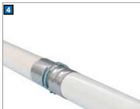
*Снимите пресс-обойму. После опрессовки изменение формы гильзы отчётливо заметно визуально.*
