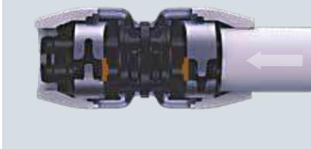
*В момент вставки металлополимерной трубы в фитинг RTM происходит выталкивание цветного фиксатора, удерживающего стальное преднапряжённое кольцо. Процесс также сопровождается ясно слышимым щелчком. Специальная прозрачная конструкция позволяет визуально наблюдать, что фиксаторы сдвинуты, что означает, что монтаж герметичного соединения завершён, система готова к эксплуатации.*
