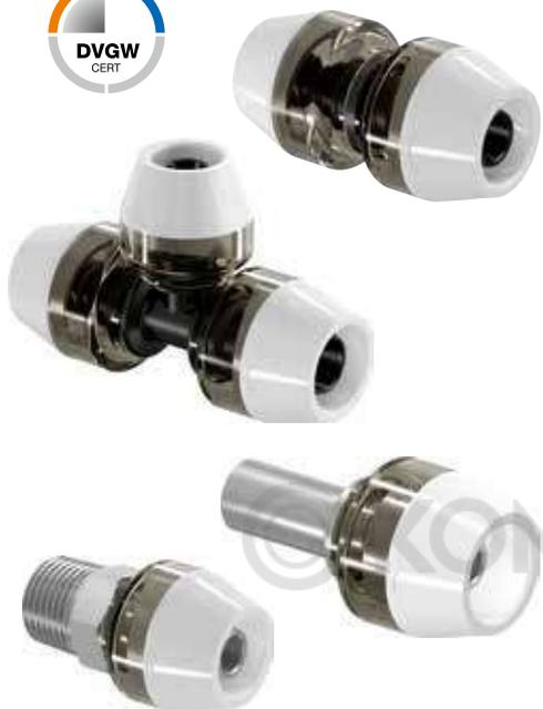
Технология фитингов Uropog RTM предлагает очень удобную и функциональную систему соединения труб небольших диаметров. Вам не требуется какой-либо инструмент для создания герметичного соединения. Достаточно просто вставить трубу в фитинг соответствующего диаметра и функция „инструмент внутри“ фиксирует соединение за счёт стального преднапряжённого кольца, которое прослужит в течение всего периода эксплуатации системы.
