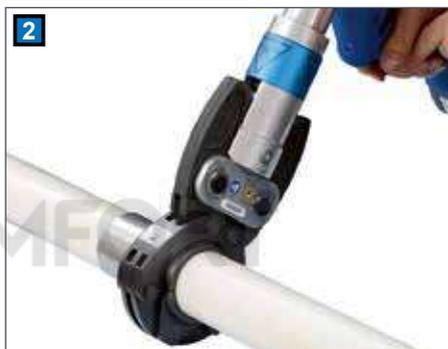
*Предварительно снимите внутреннюю фаску с конца трубы, отрезанной под прямым углом. Вставьте фитинг до упора (контроль по смотровому окошку). Разместите пресс-обойму с совпадающей цветовой кодировкой на пресс-гильзе, прижав её к цветному упорному кольцу.*
