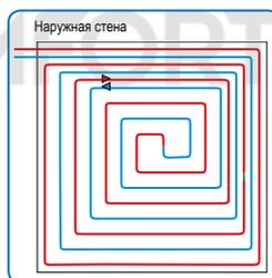
Применение меньшего шага укладки в граничных зонах вдоль наружных стен дает более высокие температуры поверхности и, следовательно, большую теплоотдачу в этих зонах.
