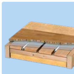
Тёплый пол сухой конструкции с пластинами распределения тепла
