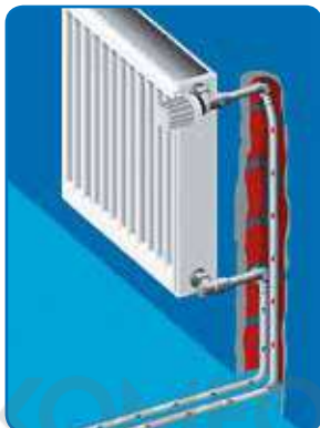
б) Подключение радиатора «боковое, от стены» с помощью хромированных медных пресс угольников. Присоединение медных пресс угольников к радиаторному узлу осуществляется резьбовыми адаптерами для медных трубок.
