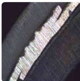
Шов алюминия, сваренного внахлест
