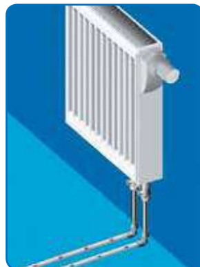
е) Подключение радиатора «нижнее, от пола» с помощью хромированных медных пресс угольников. Присоединение медных пресс угольников к радиаторному узлу осуществляется резьбовыми адаптерами для медных трубок.
