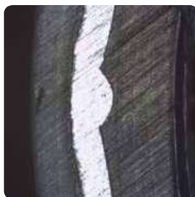
Шов алюминия, сваренного встык
