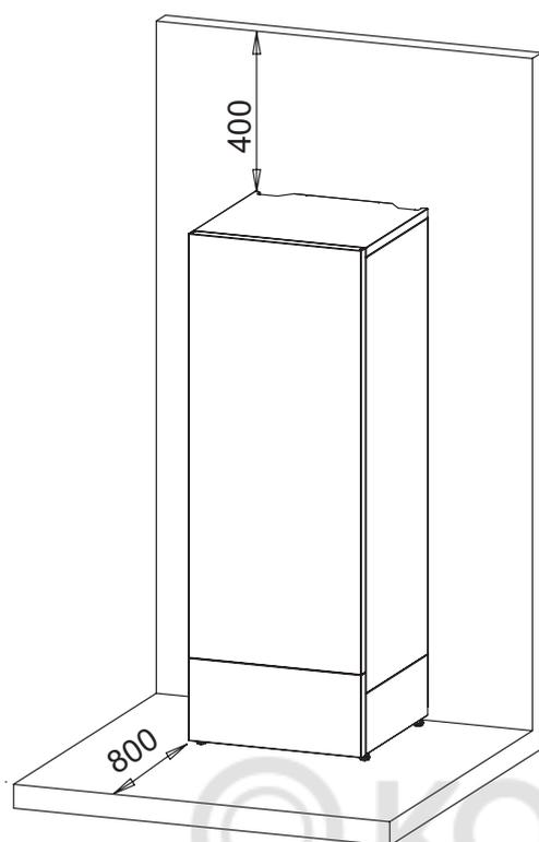
Водонагреватель – вертикально стоящая модель и требуемое ему пространство в моделях на 220 и 300 л: 600 мм х 600 мм и в 500 л: 730 х 730 мм. Водонагреватель устанавливают в вертикальном положении, в сухом помещении, вблизи дренажного колодца. При выборе места установки учесть также, что сливную трубу предохранительного клапана можно подвести к находящейся рядом канализации, и что при необходимости можно произвести дренаж водонагревателя.
