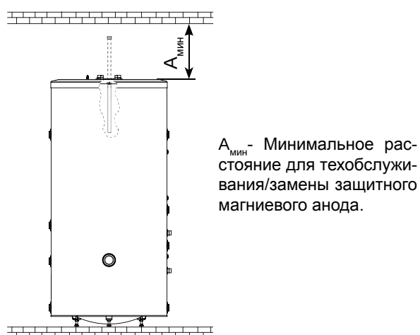
Рис. 5 Минимальное расстояние для техобслуживания/замены защитного магниевого анода.
