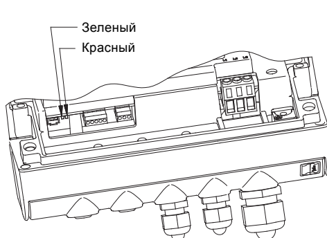
Рис. 37 Световые индикаторы на насосах с однофазными электродвигателями
