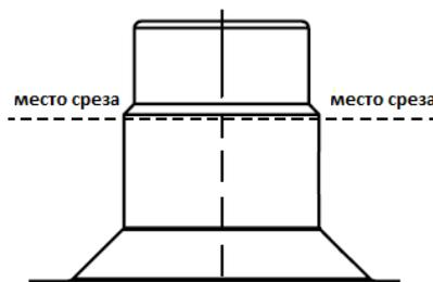
ПРИ МОНТАЖЕ КАТЕГОРИЧЕСКИ ЗАПРЕЩАЕТСЯ КРЕПИТЬ К КОРПУСУ КЕССОНА ЧТО-ЛИБО С ПОМОЩЬЮ БОЛТОВ, ШУРУПОВ, ГВОЗДЕЙ И Т. Д., НАРУШАЯ ГЕРМЕТИЧНОСТЬ КЕССОНА.
