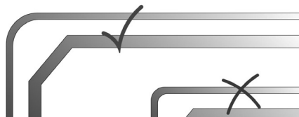
Рисунок 8 – Все изгибы должны иметь плавный переход
