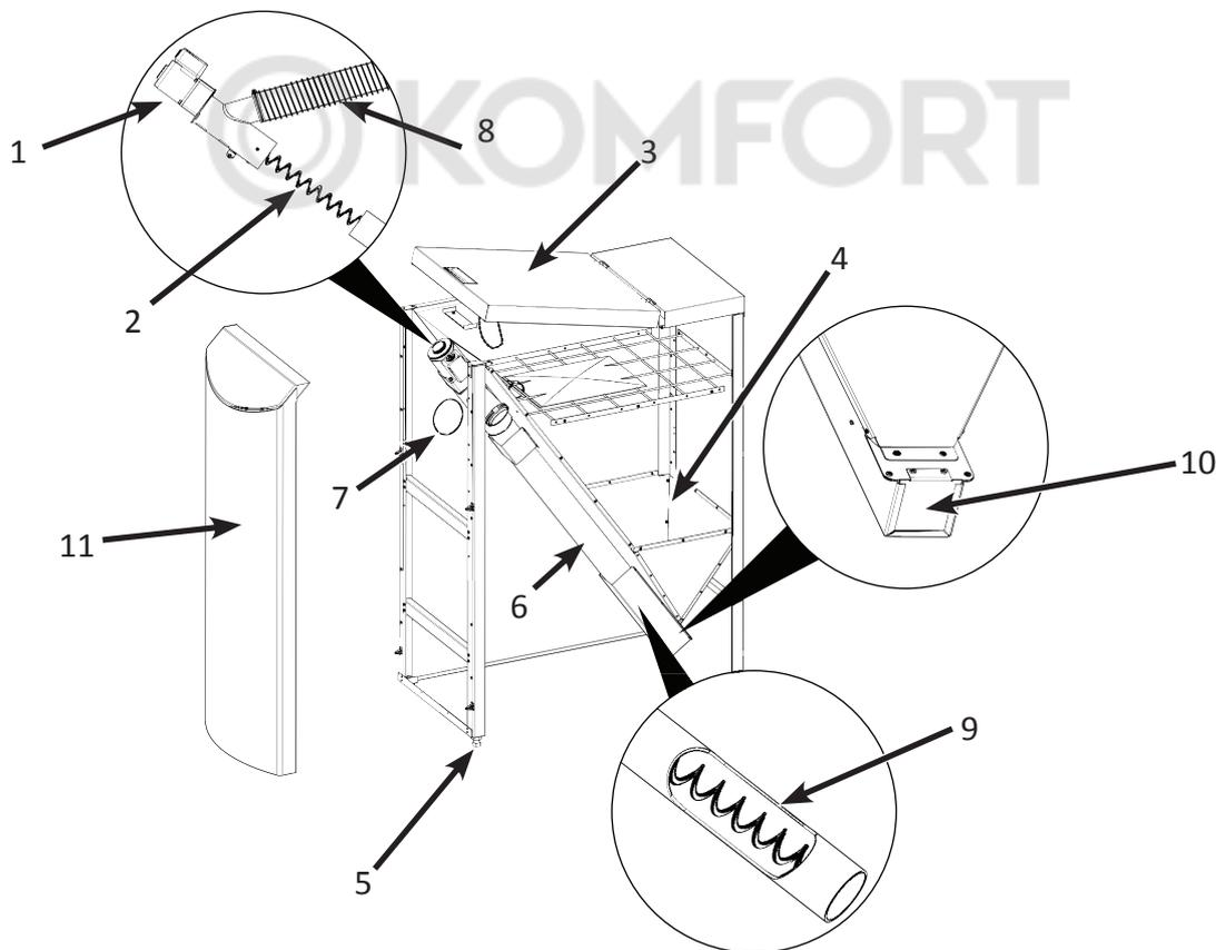
Рис. 3 Конструкция комплекта Резервуар ZP200 + Механизм подачи PP10
