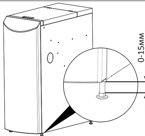
Рис. 6 Горизонтальное выравнивание резервуара для пеллет
