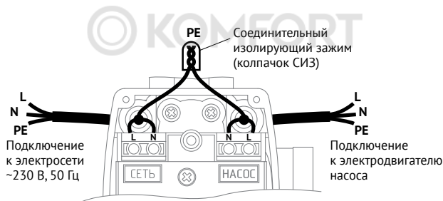
Рис. 3. Электрическая схема подключения
