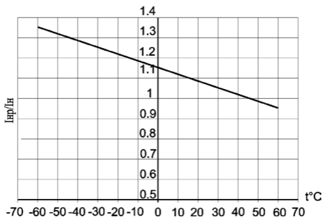
Рисунок 2 - Зависимость номинальных рабочих токов выключателей с приёмкой РС от температуры окружающей среды
