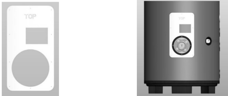
Рис.3 Установка монтажного шаблона на корпусе водонагревателя
