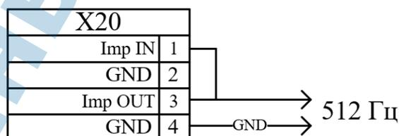
Рисунок 6 – Установка перемычки для вывода сигнала 512 Гц
