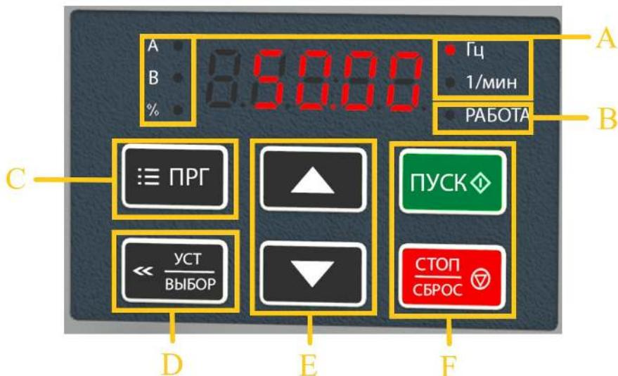
Рис.4-3. Панель управления преобразователя частоты
