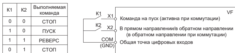
Рисунок 10.9-6. Двухпроводная схема управления 2
