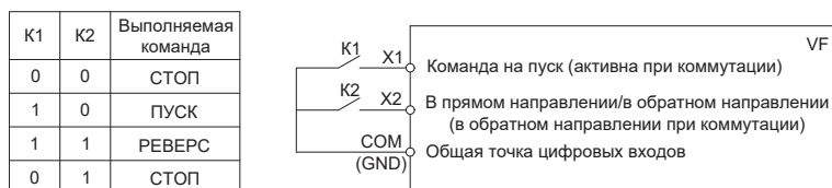
Рисунок 10.9-6. Двухпроводная схема управления 2
