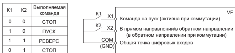
Рисунок 10.9-6. Двухпроводная схема управления 2
