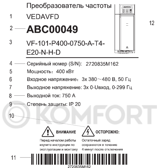
Рисунок 1.3-1. Пример маркировки преобразователя частоты
