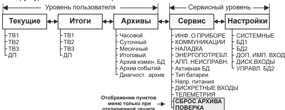
Рис. 2.6 – Структура меню тепловычислителя
