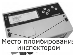
Рис. 1.2– Места пломбирования вычислителя
