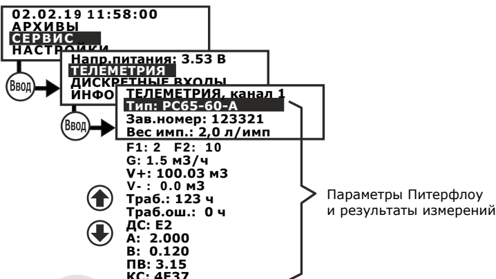
Рис. 3.11 – Порядок просмотра состояния расходомера
