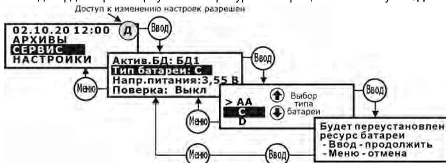
Рис.И.2 – Порядок установки/выбора типа батареи
