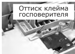
Рис. 1.2– Места пломбирования вычислителя
