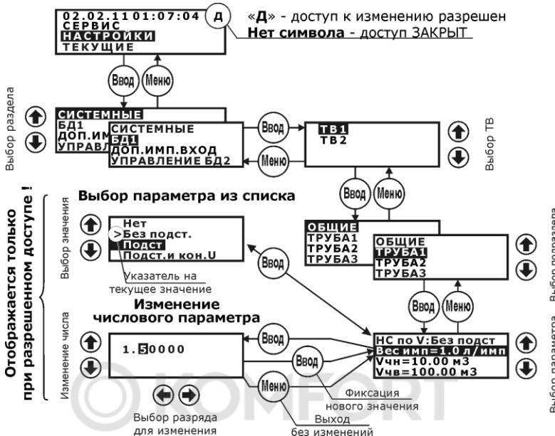
Рис. 3.1 – Пример просмотра значения параметра настройки
