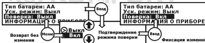
Рис. 3.13 – Включение режима поверки
