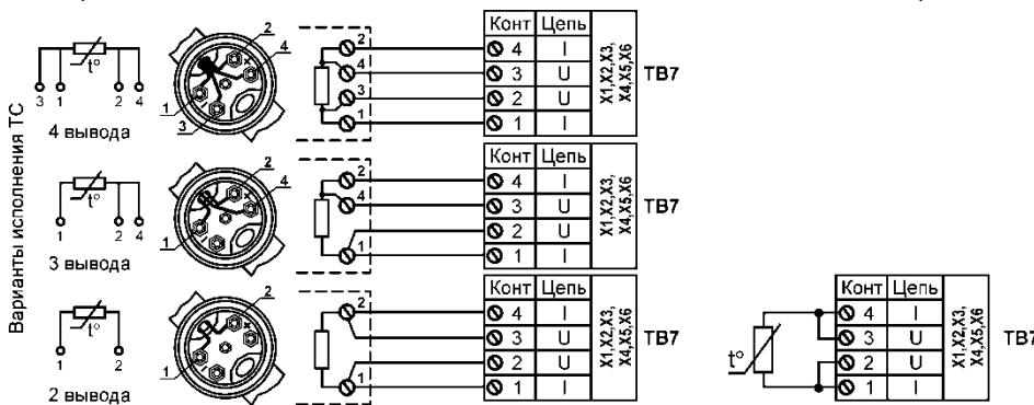
а) Подключение ТС по 4-проводной схеме
