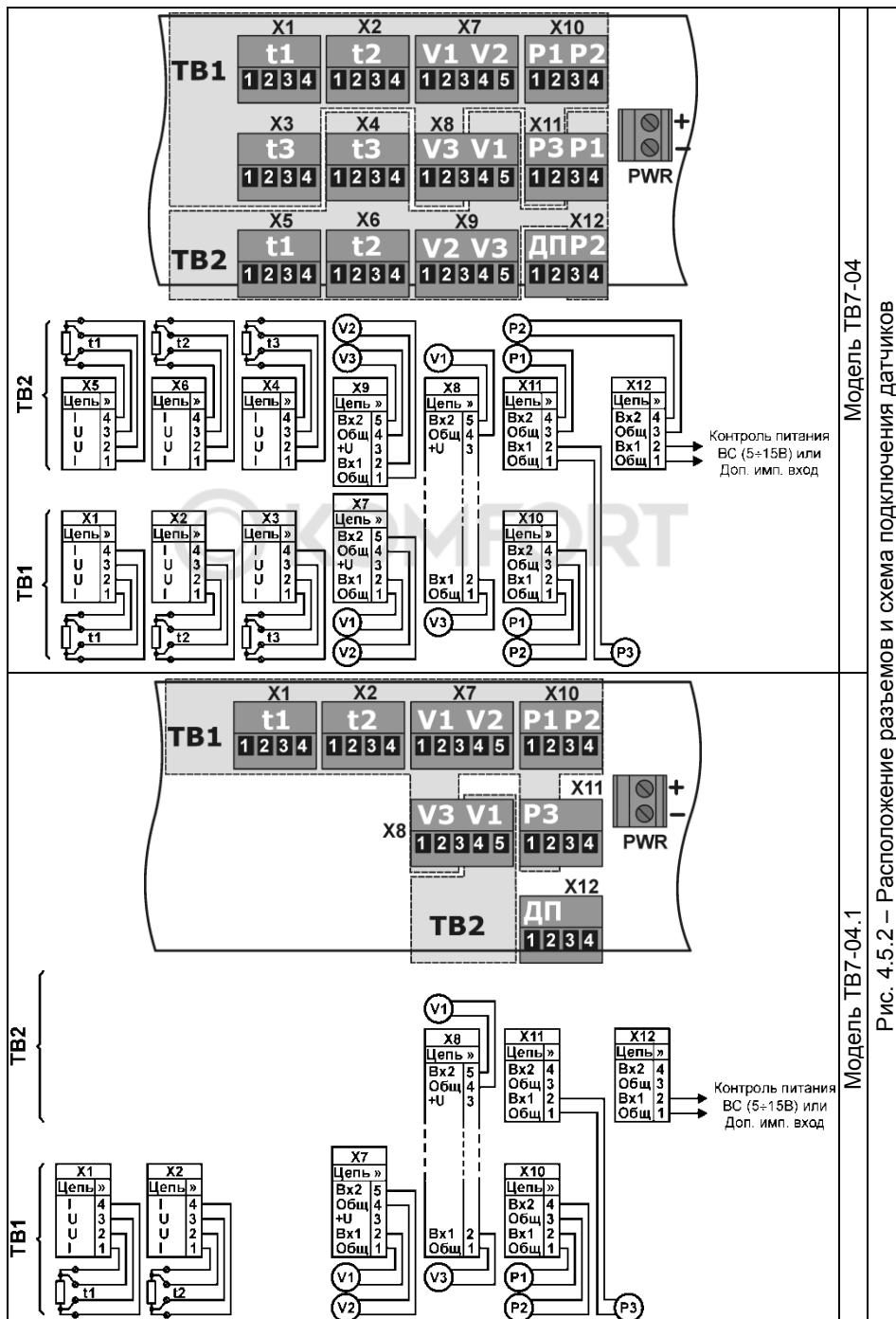
Рис. 4.5.2 – Расположение разъемов и схема подключения датчиков
