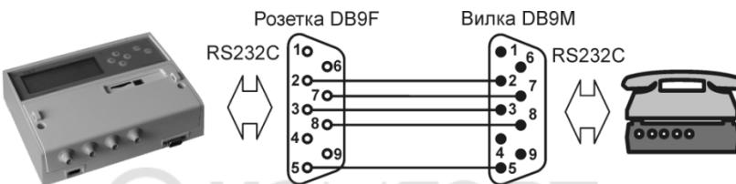
**Примечание** Для нормальной работы интерфейса RS232 напряжение между контактами RTS и GND должно быть в пределах +5,5...12В.
