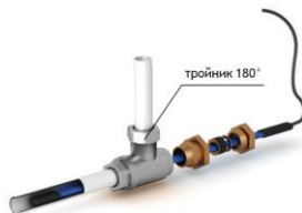
Рис. 2 - Схема прямого ввода нагревательной секции внутрь трубопровода
