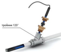
Рис. 4 - Схема ввода нагревательной секции внутрь трубопровода под углом 120°
