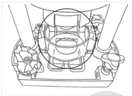
Установка насадки для сбора пыли
