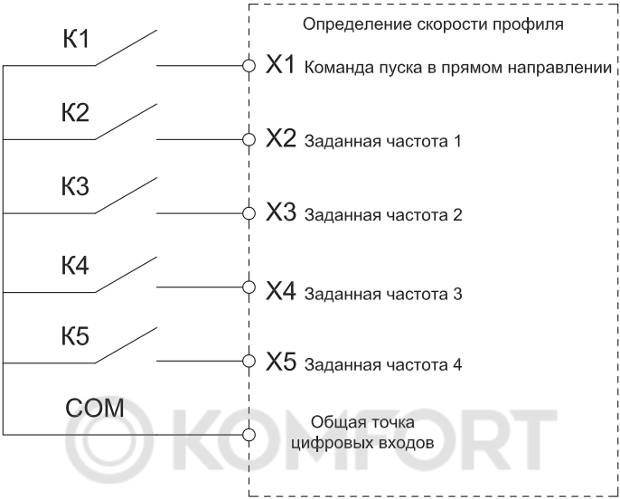
Рисунок 10.18-1. Схема подключения клемм
