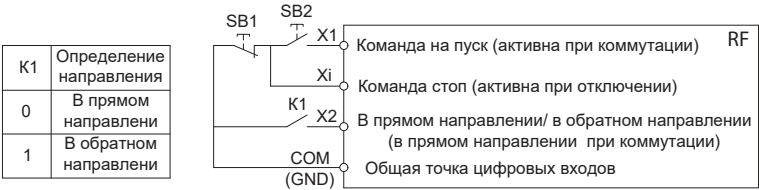
Рисунок 10.9-7. Трехпроводная схема управления 1
