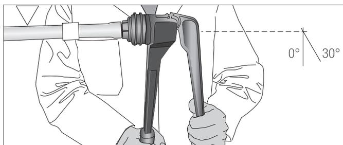
4. Вставьте штуцер фитинга в трубу до последнего ребра (до упора). Через некоторое время фитинг будет прочно держаться в трубе (память формы).
