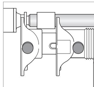
Необходимо вставлять расширительную насадку до упора в трубу! Не перекашивайте расширительный инструмент.
