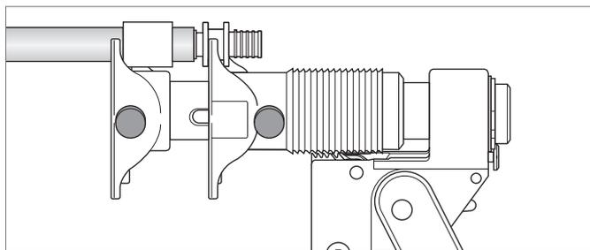
6. Переключить рычаг в верхнее положение для запрессовки соединения
