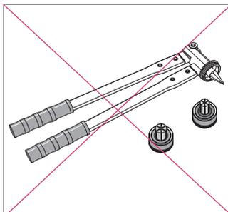
Регулярно смазывайте наконечник экспандера (тюбик со смазкой прилагается). Не смазывайте наконечник слишком обильно, чтобы смазка не попала в трубу.
