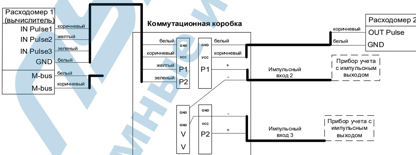
**СХЕМА ПОДКЛЮЧЕНИЯ ТЕПЛОСЧЕТЧИКА С ДВУМЯ РАСХОДОМЕРАМИ, ДВУМЯ ИМПУЛЬСНЫМИ ВХОДАМИ И УЧЕТОМ ОБРАТНОГО ПОТОКА НА ДВУХ РАСХОДОМЕРАХ, RS-485**
