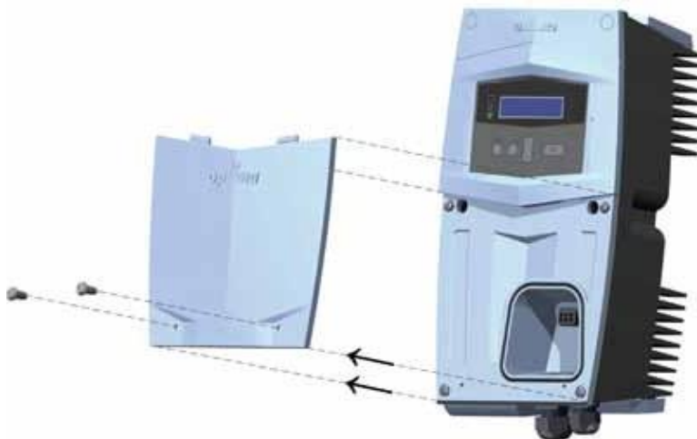
Рисунок 6.8: Демонтаж нижней крышки
