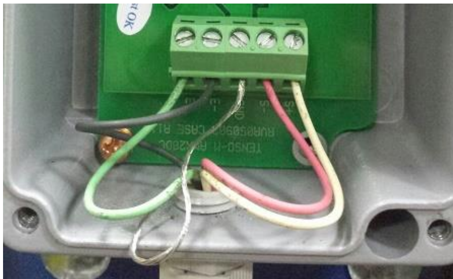
Схема 2. Подключение тензодатчика к усилителю.
