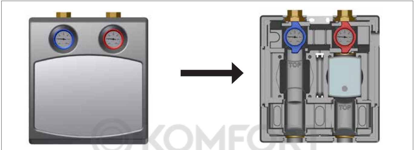
Рис. 3: Демонтаж фронтальной секции насосного модуля (на примере НК/НКМ 8130)
