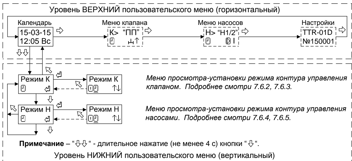
Рисунок 7 - Структура меню настройки режима работы контура
