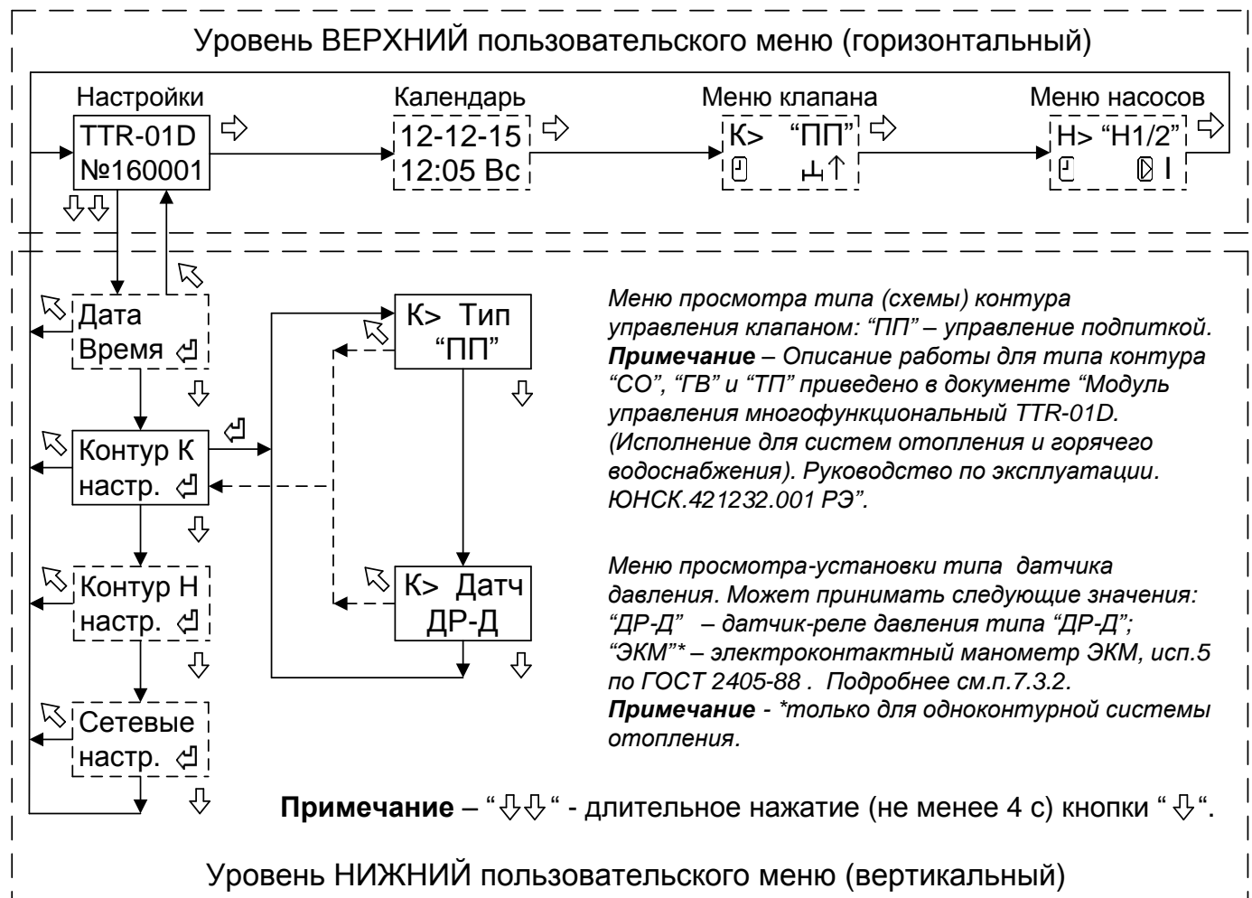
Рисунок 4 - Структура меню настройки параметров контура клапана подпитки
