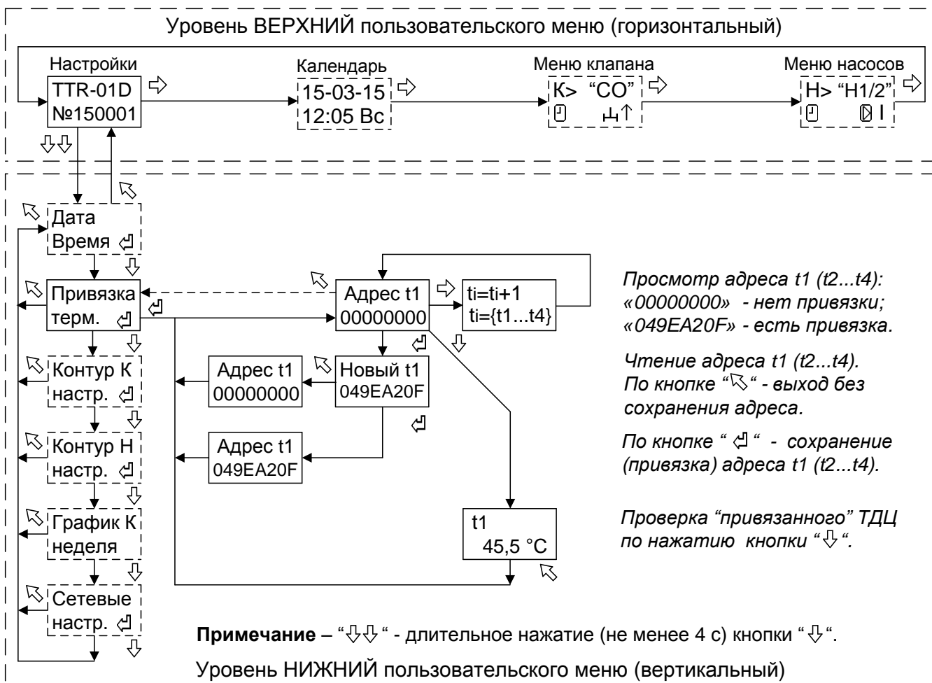
Рисунок 3 - Пример программирования (привязки) ТДЦ
