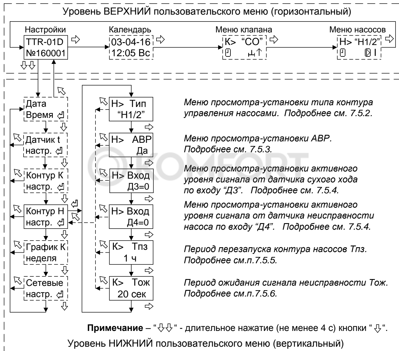
Рисунок 9 - Структура меню настройки параметров контура управления насосами.
