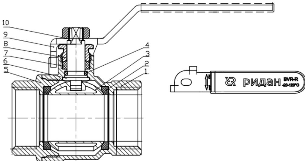
Рис. 2 Конструкция шарового крана DN65-100
