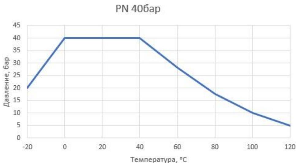
рис.3: Зависимость рабочего давления от температуры перемещаемой среды
