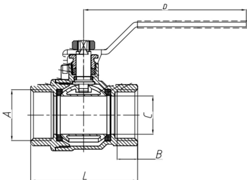
рис.4: Габаритные и присоединительные размеры
