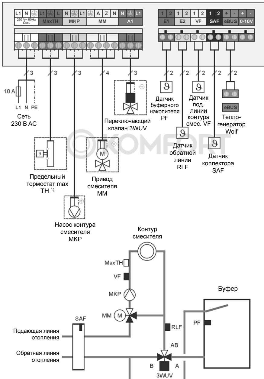
**Конфигурация 6:** контур отопления и подъем температуры в обратной линии для пусковой разгрузки
