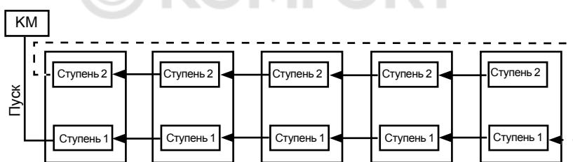
**e, f, g) KM02 = 5/6/7: одноступенчатые переключающие тепловые насосы + дополнительный теплогенератор (1-ступенчатый, 2-ступенчатый или регулирующий)**
