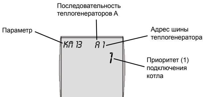
Настройка последовательности теплогенераторов показана на примере с двумя теплогенераторами.
