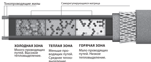
Рисунок 2. Принцип саморегулирования кабеля
