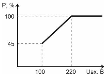
Рисунок 2. График зависимости выходной мощности от входного напряжения.
