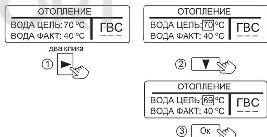
Рисунок 7. Настройка температуры теплоносителя
