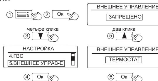
Рисунок 19. Настройка работы от внешнего устройства
