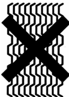
Рисунок Б.3 – Вид пакета пластин при неправильной сборке
