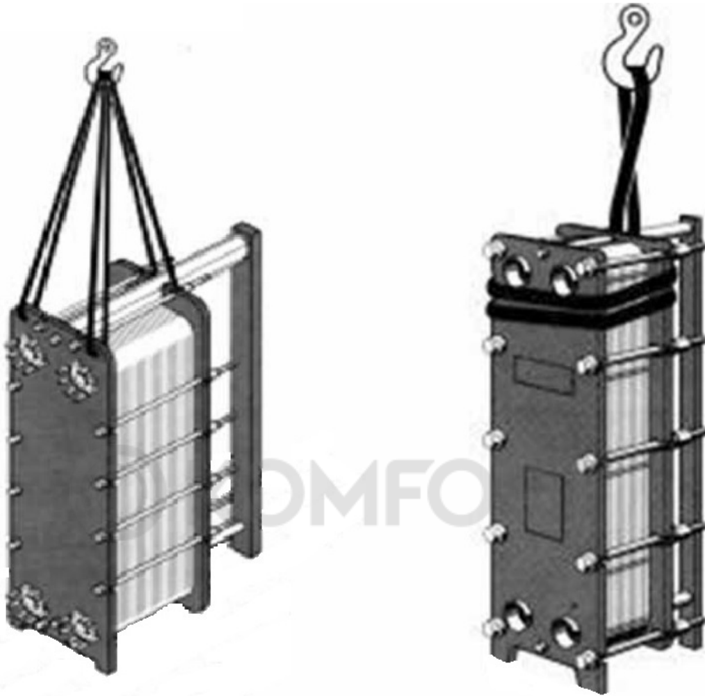
Строповка теплообменника с транспортировочными отверстиями
