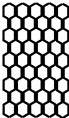
Рисунок Б.2 – Вид пакета пластин при правильной сборке
