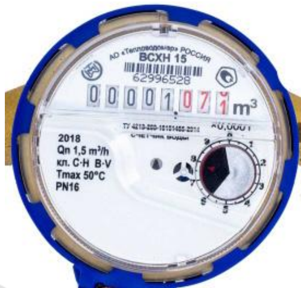
Рисунок 1. Счётный механизм счётчика BCXH-15
