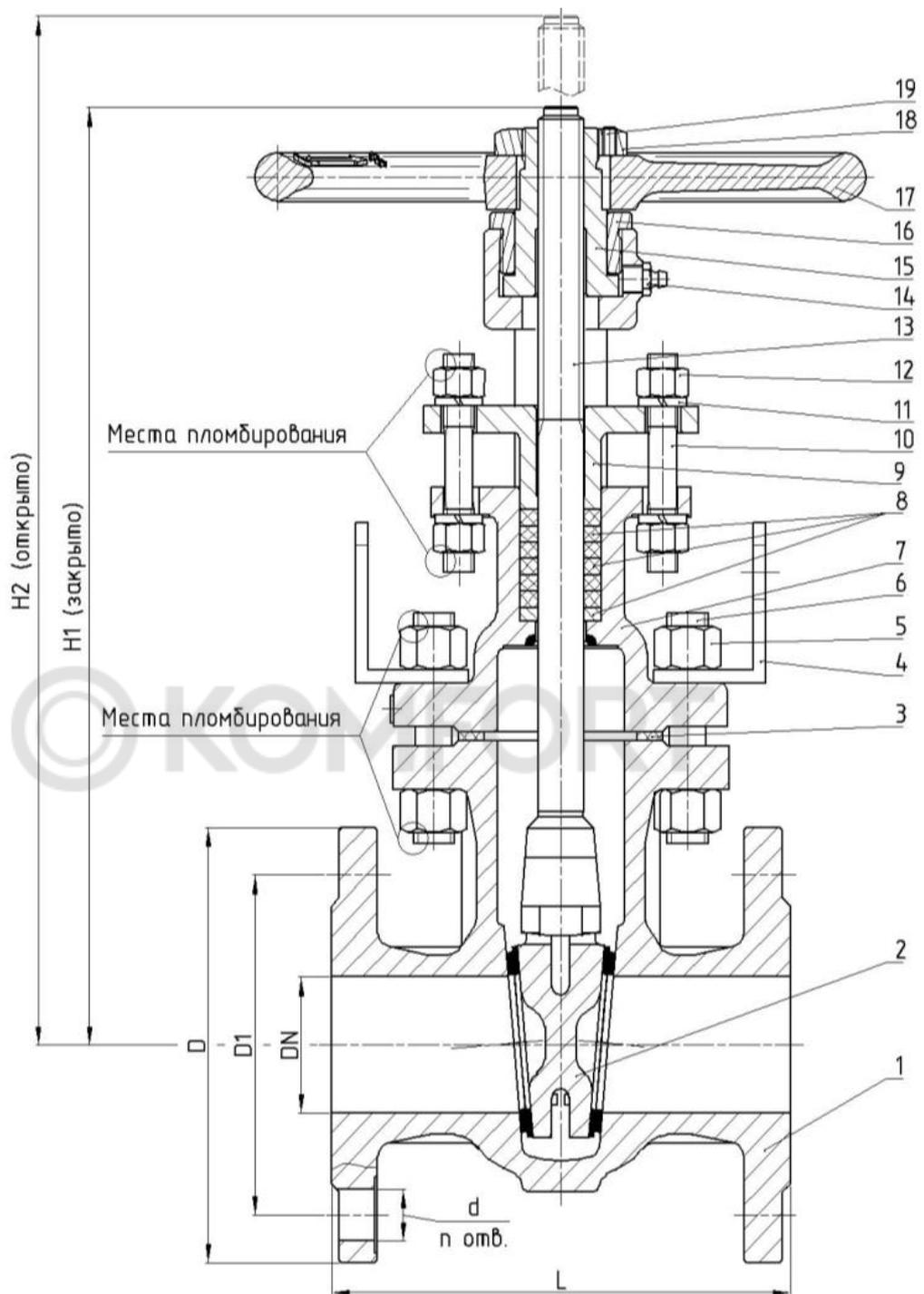
1–Корпус; 2–Клин; 3–Прокладка; 4–Кронштейн; 5–Гайка; 6–Шпилька; 7–Крышка;
