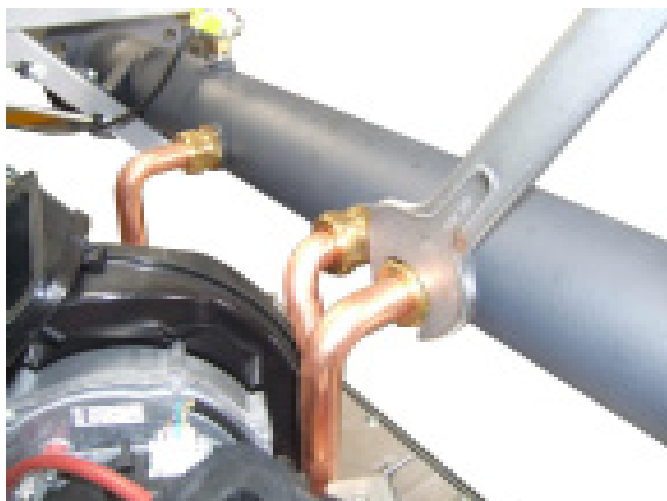
- Снять газовые фитинги с газового коллектора с помощью гаечного ключа 36 мм.
