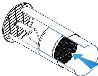
**ПОЛОЖЕНИЕ ДЛЯ КРЕПЛЕНИЯ БЛОКА ВЕНТИЛЯТОРА**
