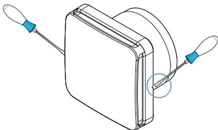
Снимите крышку с держателя двигателя, нажав на 2 боковых отверстия маленькой отверткой.
