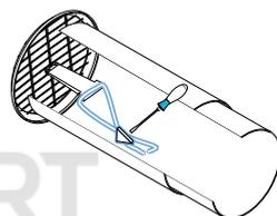
Закрепите кронштейн на трубе и закрепите шнурок в боковых прорезях.
