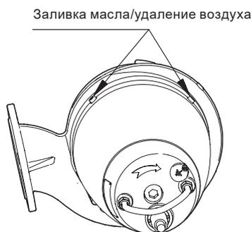
Рис. 22 Отверстия для заливки масла
