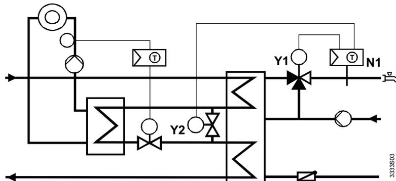
Прямой нагрев ГВС через теплообменник, Y1 управляет смешивающим клапаном контура ГВС, Y2 управляет 2-ходовым клапаном первичного контура ГВС
