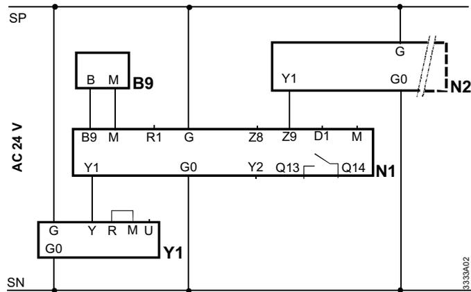
Управление температурой подающей воды, компенсацией по наружной температуре и ограничением по максимуму температуры подающей
