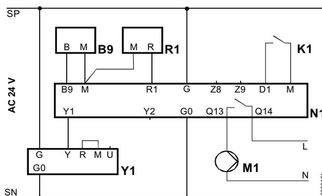
Температура на притоке с компенсацией по наружной температуре, удаленным датчиком, переключателем уставок и управлением насосом
