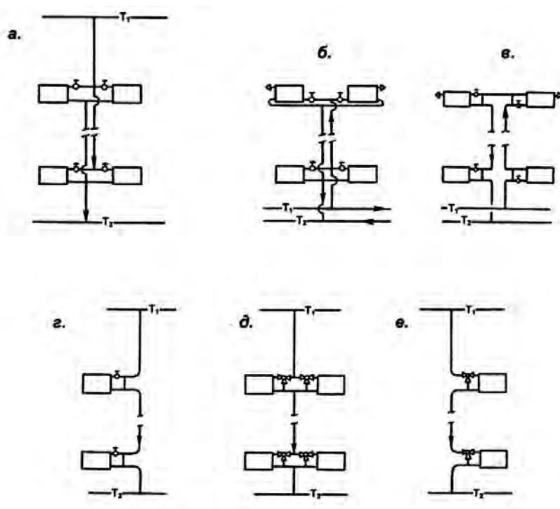
Рис. 2.2 Схемы вертикальных стояков систем водяного отопления:
