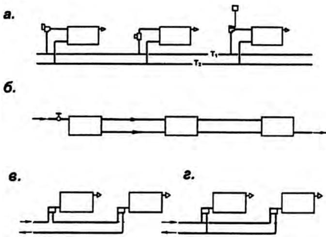
*Рис. 2.3 Схемы горизонтальных систем водяного отопления:
