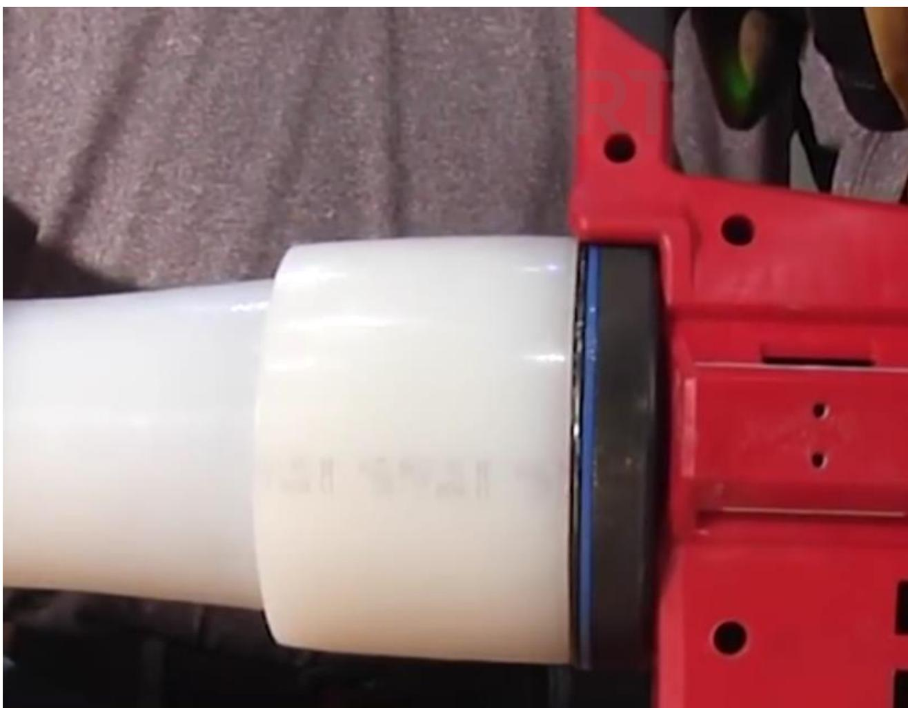
Примечание: если при расширении слышны нехарактерные посторонние звуки (щелчки), остановите расширение, однократным нажатием на кнопку пуск, верните лепестки в исходное положение, нажав на кнопку возврата (с левой стороны, под гнездом аккумулятора), и убедитесь, что головка установлена правильно. В противном случае есть риск заклинивания инструмента.
