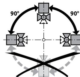
**Установка на секции обратной воды** В качестве общего правила, кран устанавливается на обратной воде.
