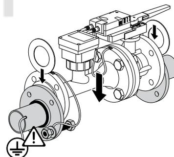
**Входная секция** С целью достижения высокой точности измерения необходимо обеспечить наличие специального участка трубы для снижения скорости потока в противоположной стороне от фланца измерительной трубы. Длина участка должна быть не менее  $5 \times \text{DN}$
