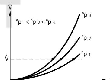
Требуемое текущее значение расхода V при изменении перепада давления на клапане Δр обеспечивается изменением угла поворота α. Таким образом, текущее значение расхода V не зависит от перепадов давления в системе, а изменяется только путем изменения управляющего сигнала, поступающего на привод.
